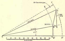
Fig. 113.—Solution with 600,000-cir. mil conductor.
